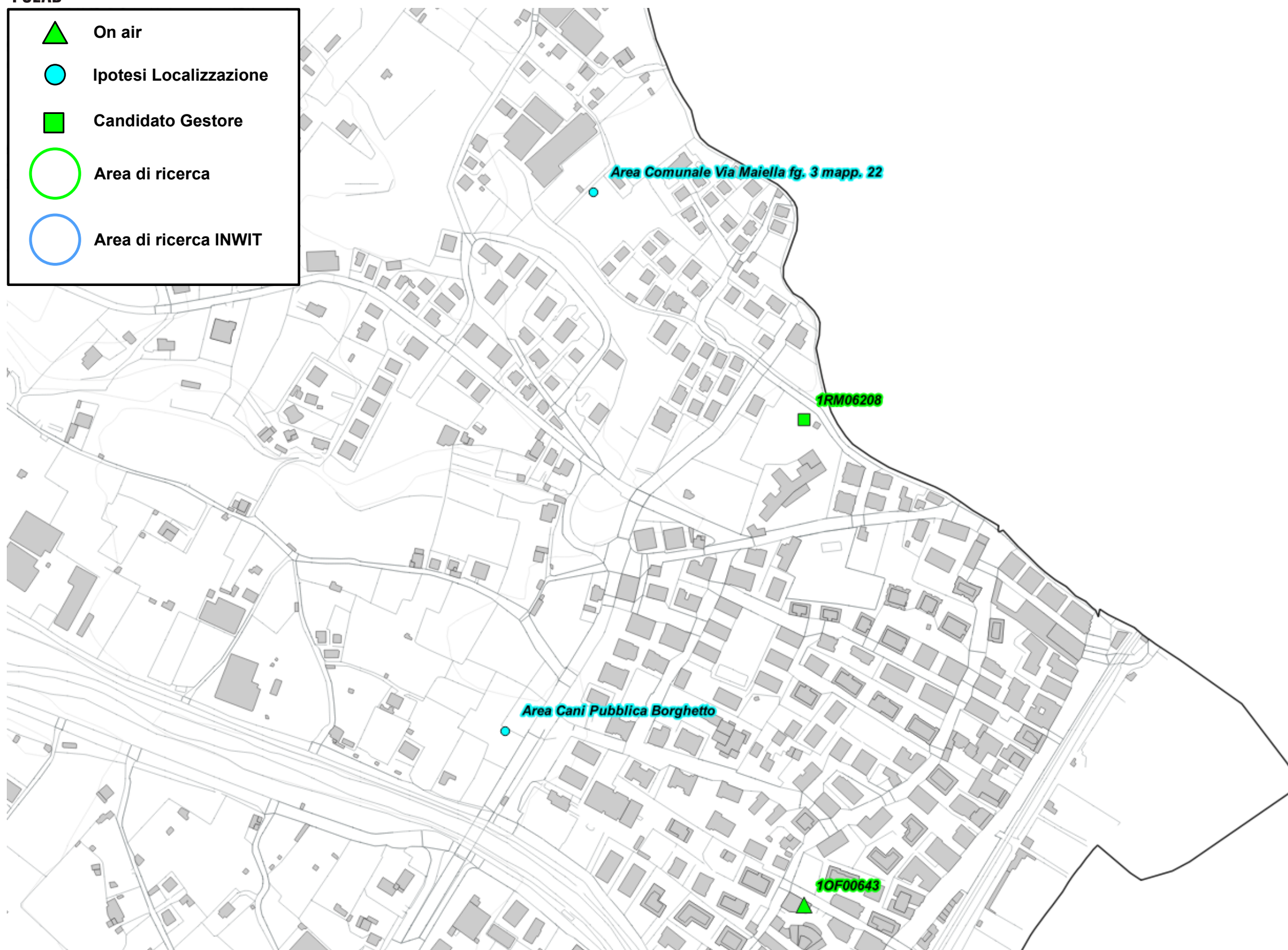
Fig. 14 Dettaglio piano di rete – Gestore VODAFONE
